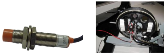
Figura 6 – Sensor de proximidade indutivo e pormenor de aplicação.
